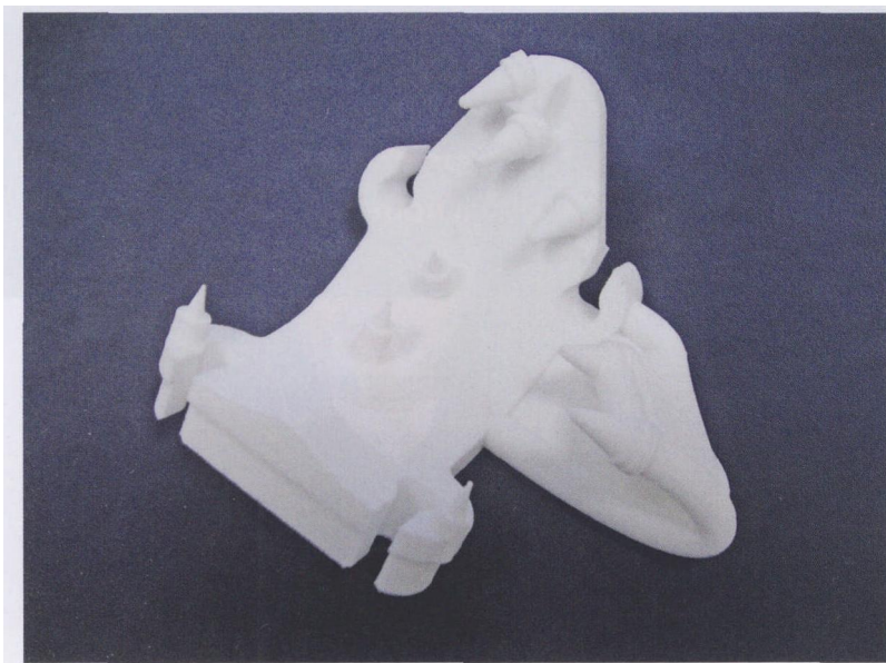
图2 Directed Manufacturing 公司已经成功地开展了塑料部件的增材制造业务，图中用于膝盖外科手术的对准工具就是为了对患者进行 CAT 扫描测量而定制的，该公司期望为类似于其已提供的塑料部件的金属部件的制造提供服务
