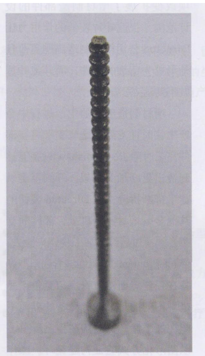
图3 Renishaw 公司生产设备的挠性叶片能够制造精巧复杂的部件外形，包括壁厚很薄的部件。图中的螺钉是在该公司设备上垂直构建而成
