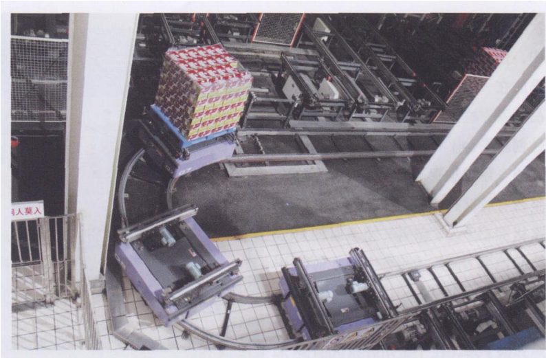
图3 无人驾驶小车负责将整垛的成品牛奶送至库口
