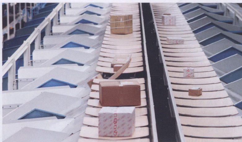
图2 BEUMER 的 E 托盘分拣机正在全球各地的邮政系统和配送中心工作着
