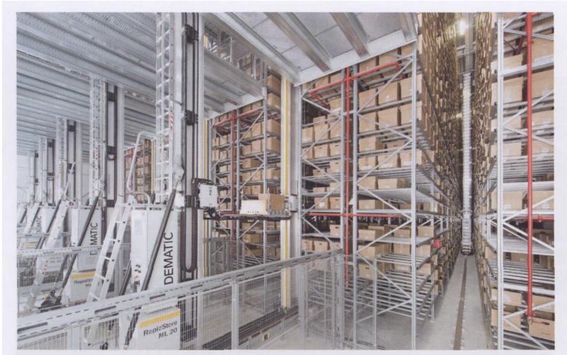
图 2 Rapid Store 高效堆垛机可以同时拿取两只纸箱，出入库时每层货架可码放三层高
