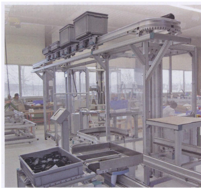
图2 Montrac 单轨解决方案达到的坡度最高至 8%，在空箱回收中优化流程
