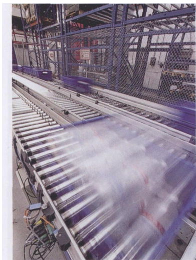
图 1 尽管输送技术中的启动力矩大，驱动装置也不需要规格超大：新型电机将标准化和高能效协调在了一起
