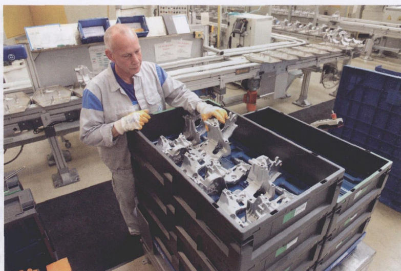
图 6 大众汽车公司发动机制造厂成功使用 QX 容器:在其正面设置有一体化的、可减轻工作人员手工作业劳动强度的底容器把手
