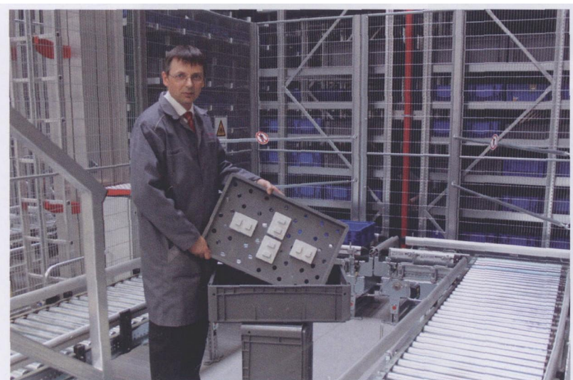
图 5 保时捷汽车股份公司的中央汽车配件仓库汽车配件物流规划人员 Joerg Reinelt 在展示一个 Bito 装料盒和 4 个插入的固定件。这些装料盒有运送货物的定位孔,以便自动化拉出所运送的货物
