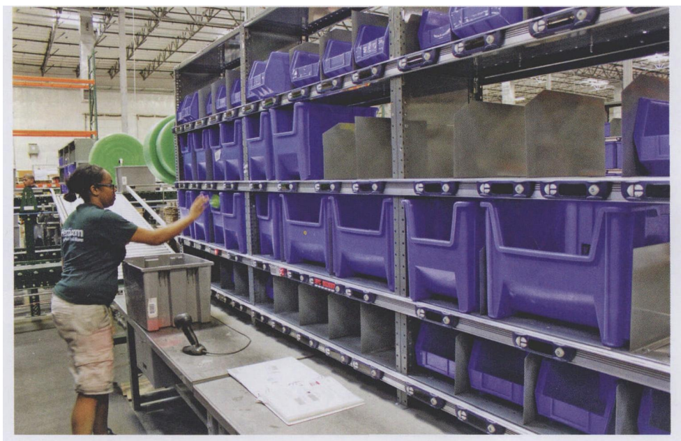
图 1 批量拣选出的不同品规商品分拣到单个订单的 PutWall 分货墙模块
