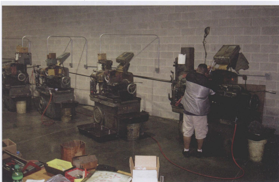
图2 这家工厂的第一台机床是凸轮驱动自动机床。厂里现在还给这些机床安排新的任务。它们的机械驱动的速度很快，但是它们要求大批量生产，因为设置时间很长
