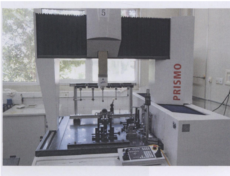
图 1 SABS 公司在成立之初就购买了一台型号为 PRISMO 7 的蔡司三坐标测量机
