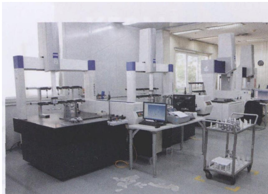
图 2 后来公司又陆续采购了多台蔡司的三坐标测量机。现今正在服役的有 3 台 PRISMO、3 台 CONTURA G2 以及 2 台 DuraMax
