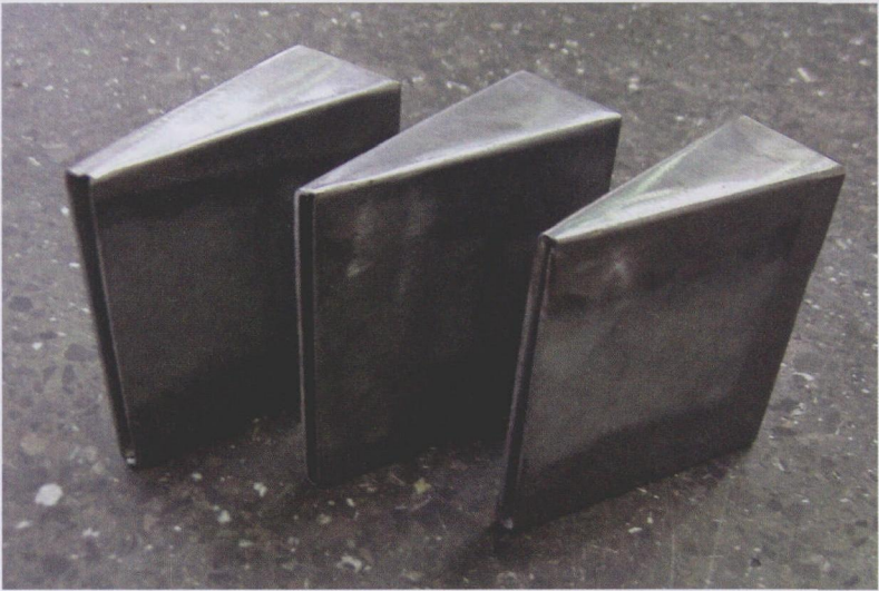
图 1 传统的自由喷射喷嘴常常能够满足深磨加工作业的冷却条件要求
