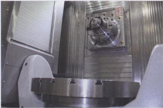
图 1 设有铣削轴和回转工作台的大作业空间
