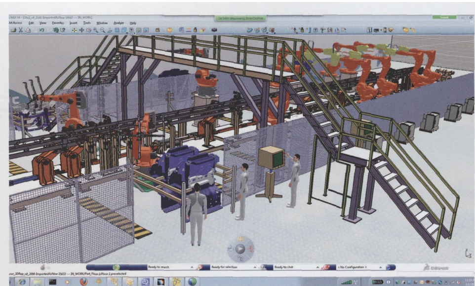
图 3 可在一个数字化机器人生产线的设计中模拟人机协作
