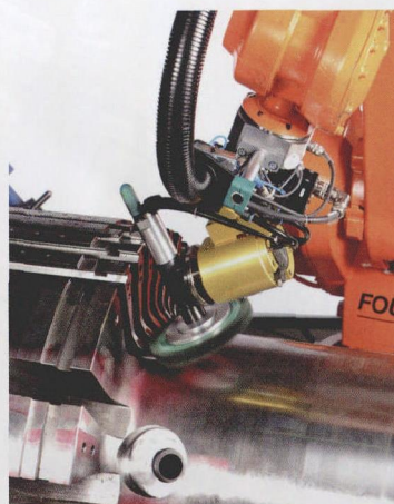
图3 气动驱动的灵活加工工具使得发电机轴去除毛刺的作业能够取得良好效果
