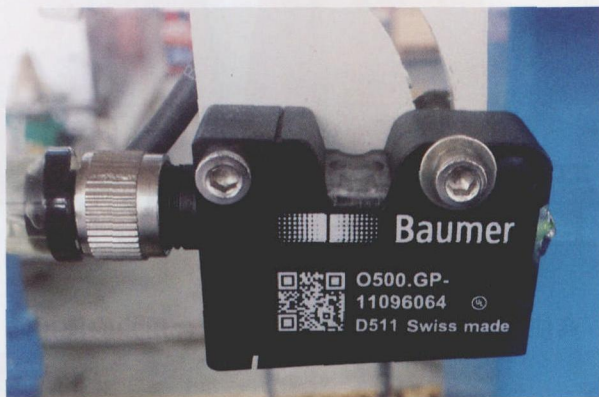
图2 堡盟 O500 光电传感器在设备中的安装工位
