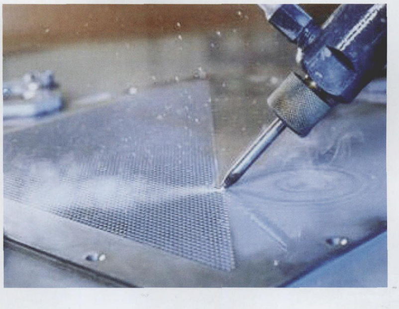
图 1 LAI 公司开发的水刀工艺可以执行离轴高精度孔加工及其他业务
