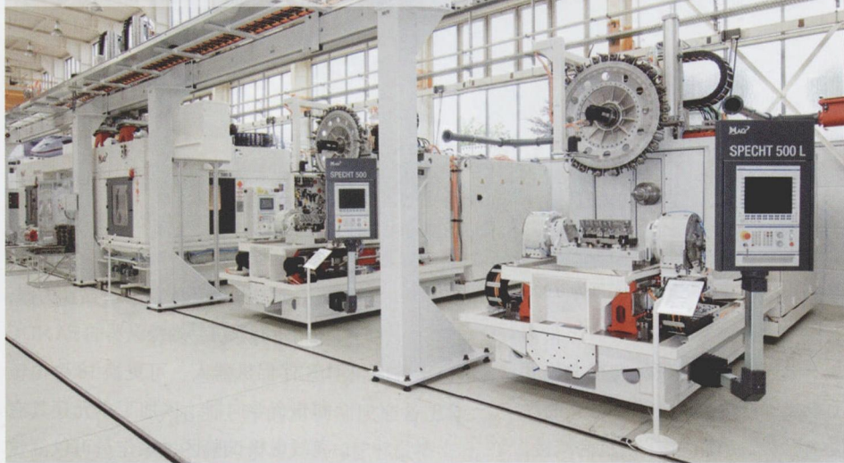
图1 建造中的由多套加工中心构成的 Agiles 系统。 网络化设备的能源效率数据可以实现分组显示
