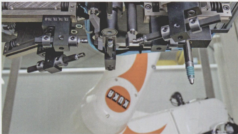
图2 该测量单元装有汽车真空泵转子测量系统
