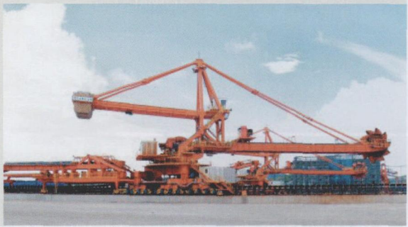
图 2 用于港口铁矿石堆场的大型堆取料机
