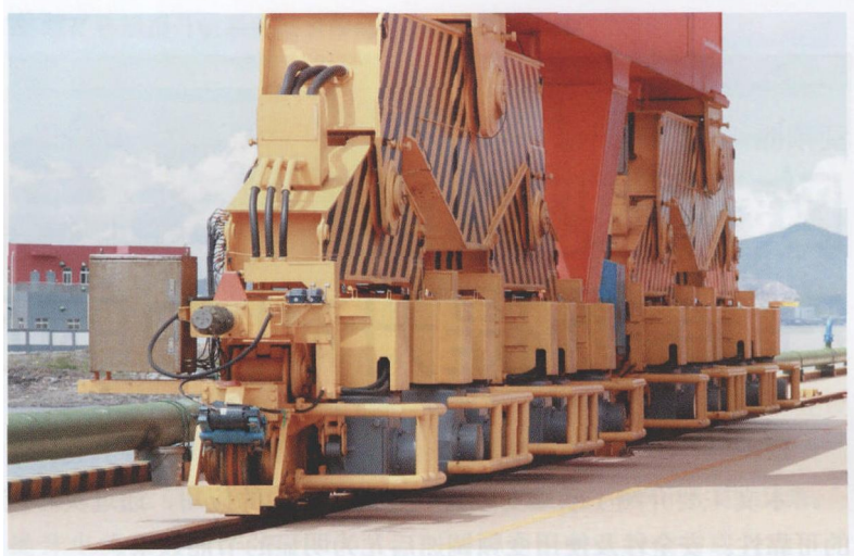
图4 诺德驱动装置沿着泊位轨道移动装船机
