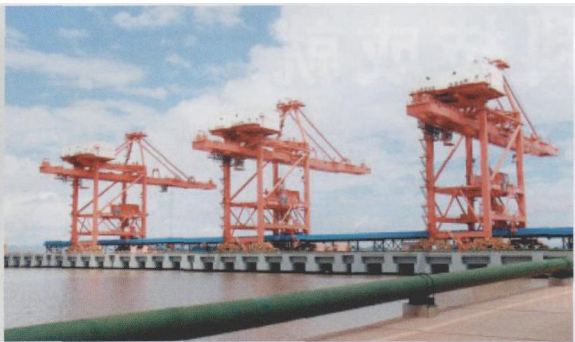
图 1 武钢港口的船用装载机和卸载机是中国同类民用机器中最大型的，每小时能处理 5000 t 铁矿石
