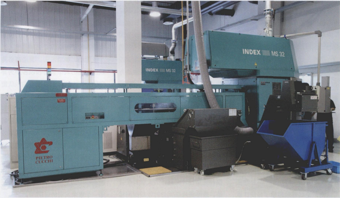
图1 INDEX MS 32型多主轴机床结合了数控技术的优点和凸轮控制的自动车床的优点
