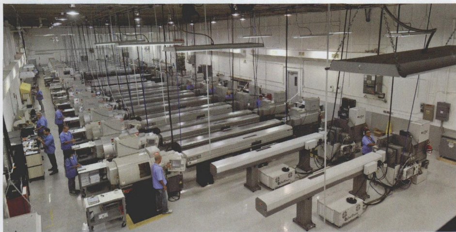
图2 3D Medical Manufacturing 公司除了有五轴机床、电火花线切割机床和机器人装载数控磨床外，还有 48 台瑞士型车床
