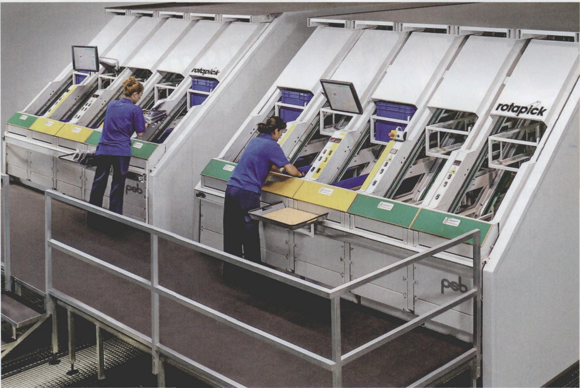
图 1 动态 Rotapick 系统可以把配货能力做到高于 1000 件/h
