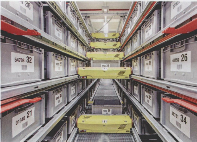
图 4 36 台往复穿梭机负责对各个区域配好的货物进行整理
