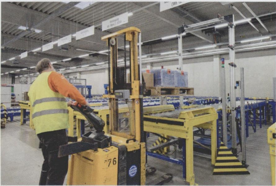
图 8 进货：载重汽车卸货后，交货用手工放到传送技术设备上
