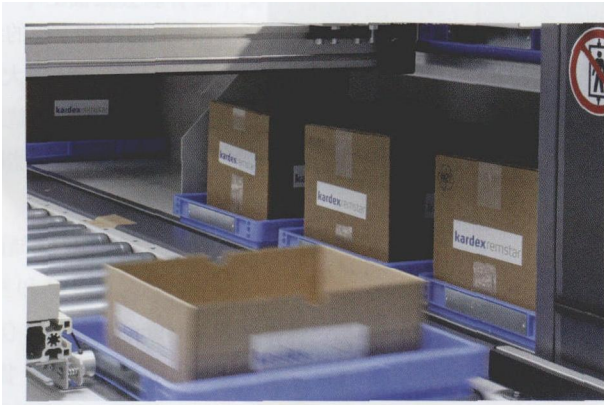
图 1 Kardex Remstar 公司新系统 Parts-4-You 仓库提升机原理与多订单取货的优点结合起来，以加速小订单的配货
