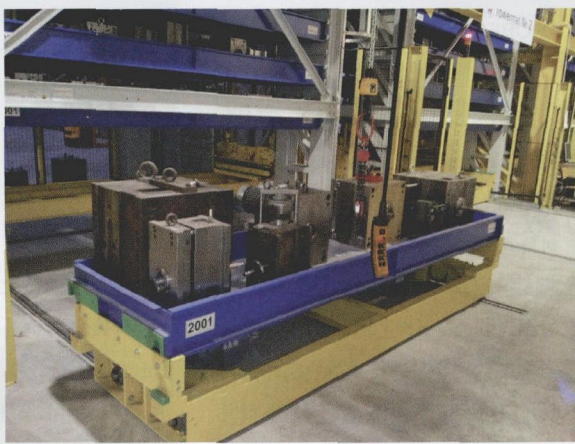
图6 三个系统总共 183 个模具盒中的每个盒均可承接总重量达 5 t 的模具
