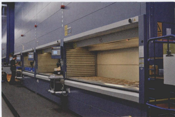
图3 在仅有 84 m 2 的占地面积上建成 1000 m 2 的仓库面积；Kardex Remstar 包括八个单元的 Shuttle-XP-500 系统在慕尼黑 Knorr-Bremse 公司用作组装缓冲存储仓库
