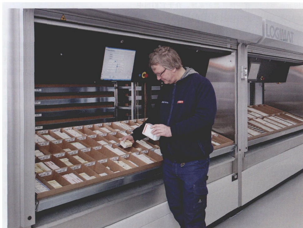
量体裁衣的能力和性能：仓库升降机系统可以针对各种不同的内部物流要求进行精确设计，并可以在控制技术和安全技术上做相应的装备
