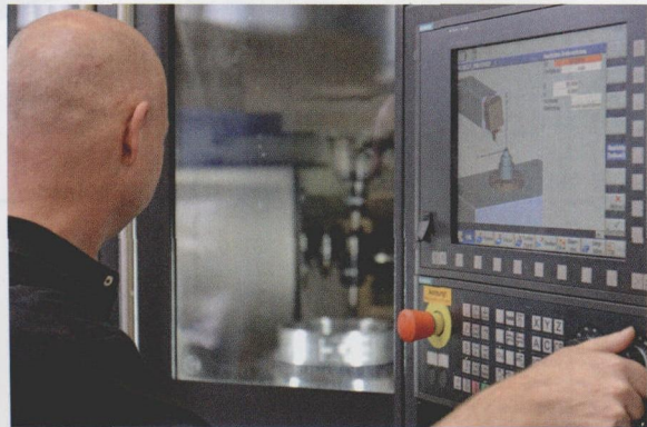
图 4 调整工作是机器操作员最困难的任务之一。因此，防撞（CA）装置在这个阶段非常重要。依据保存的机器间的数据，西门子的软件可以及时可靠地停机
