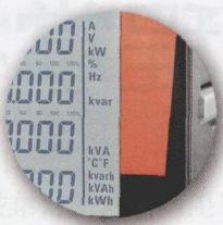
图3 Weidmüller 的电源监视器可以高精度地显示所有相关的参数。细节节点为任何一个连接的相上以及总计行上的电流、电压、功率、有效功率因数、视在功率和无功功率
