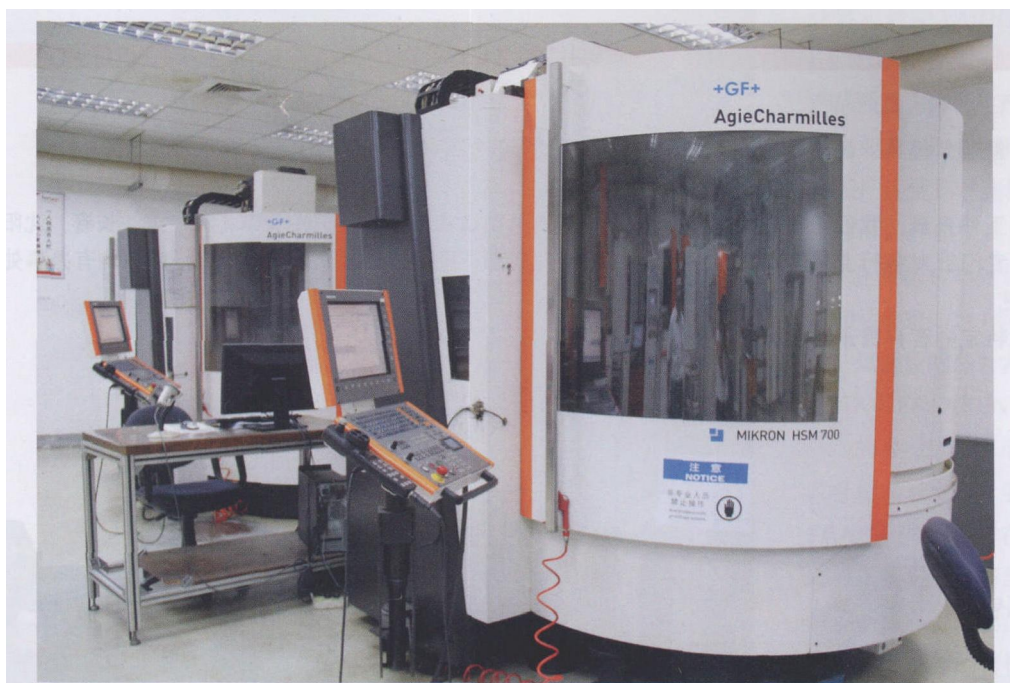
图 1 配有海德汉 iTNC530 数控系统的 MIKRON HSM700 高速铣削加工中心
