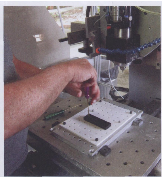
图3 测头决定了工件设置在工作台上的真实位置，并通过移动坐标系统来进行补偿，这就避免了使用千分表和传统设置方法对工件准确定位所带来的固有挑战
