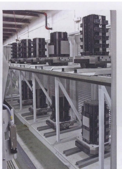
图 2 10 台定制的 Triag 模块化墓碑式夹具帮助 TRD 公司增产 40%
