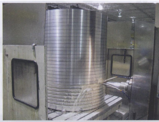
图 3 在一台 VTL 立式转塔车床上铣削一条更深的沟槽
