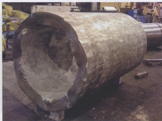
图 2 用于线圈制造的圆柱形铝金属锻件
