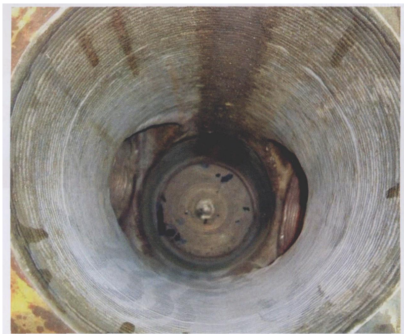
图 1 在井架上完成镍基合金油井管的加工
