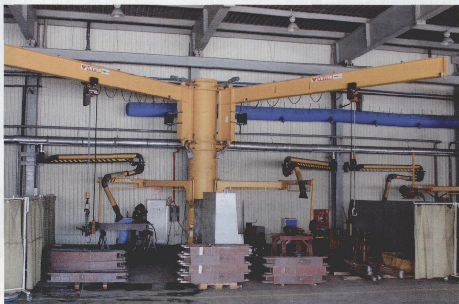
图 5 装有 Vetter 回转起重机的焊接岗位岗位
