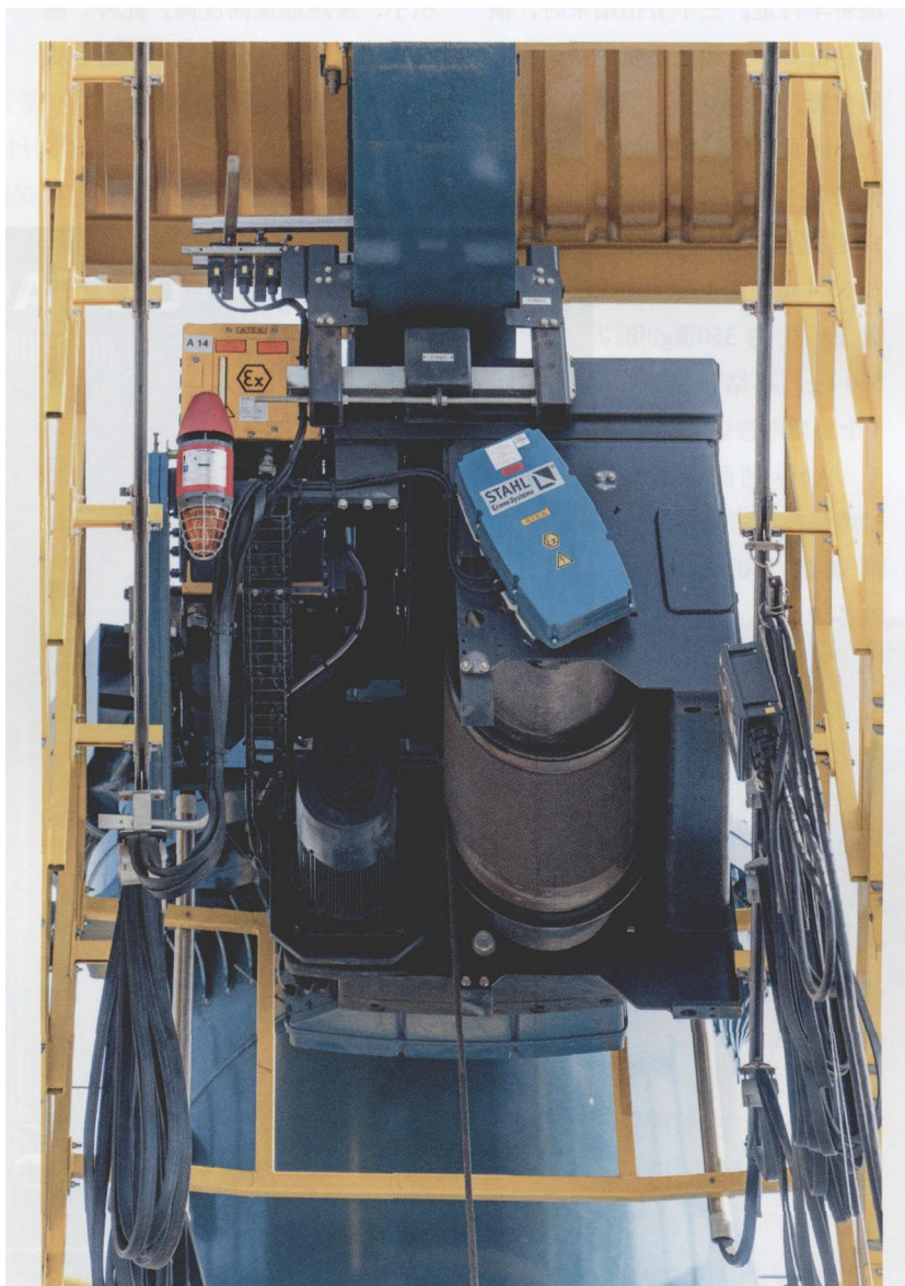
图 1 STAHL CraneSystems 特殊定制的 LNG 葫芦符合 ATEX 指令，因此适用于危险区域
