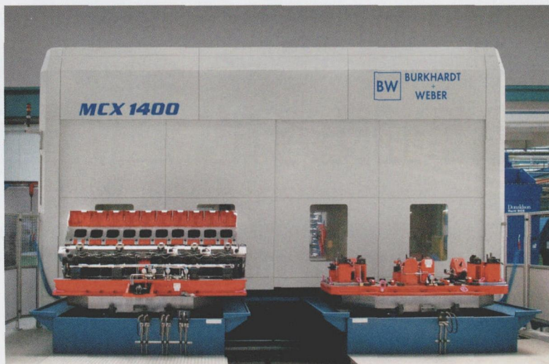
图 2 两个托盘在加工过程中被支撑，工件最大承重为 12 t
