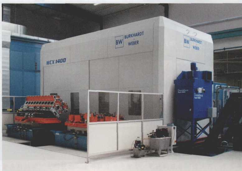
图 1 MCX1400 加工中心，是世界上大型卧式加工中心之一，配置特殊装置进行燃气发动机 V 型缸体的加工
