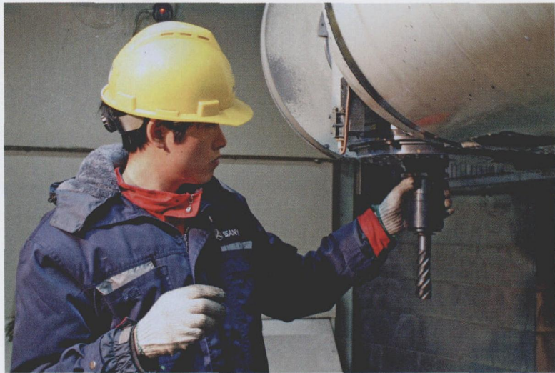
图 3 三一电气刀具操作人员正在安装瓦尔特丝锥
