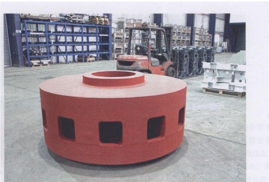
图 2 重达 18 800 kg 的固溶强化型球墨铸铁材料浇铸的水泥磨机轴承座
