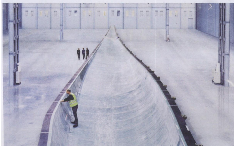
图4 B75 风力发电机玻璃纤维增强转子叶片，就生产时的情况提出了一些新的要求：转子叶片要分成两体，以便于运输
