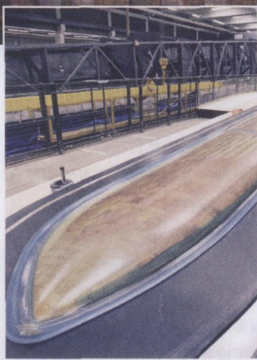
图7 利用 Integral-Blade-Verfahren 制造出来的转子叶片几乎无需修正，转子叶片非常坚固、成本低廉
