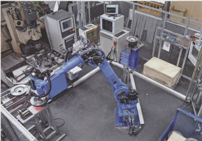
图 4 读取追溯所用的数据，以及完成加工和检测之后，机器人将刹车盘六个一层放入板条箱内，并在变更夹具后用一块木板盖在上面
