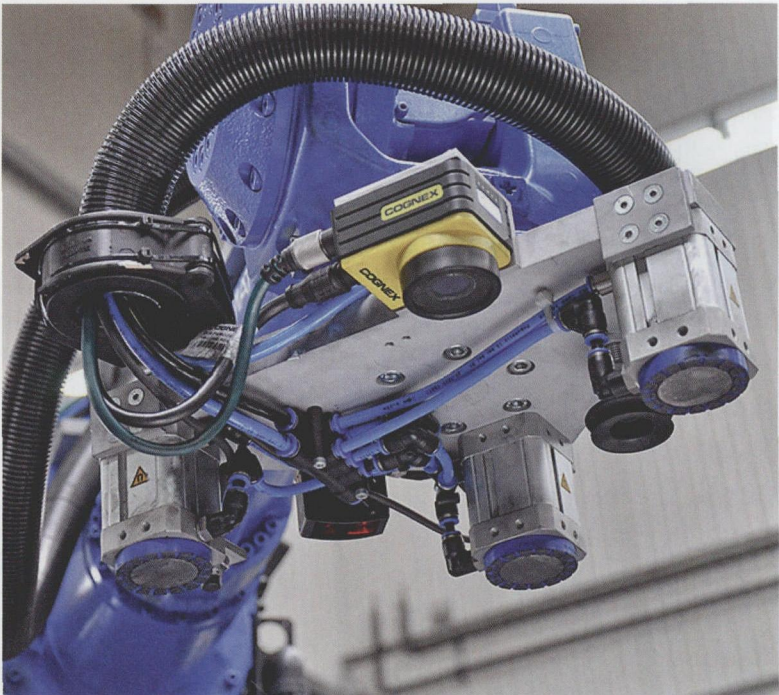
图 2 机器人顶部的视觉系统控制着整个操作过程，也就是从抓取刹车盘到加工过程结束后放下工件的整个过程
