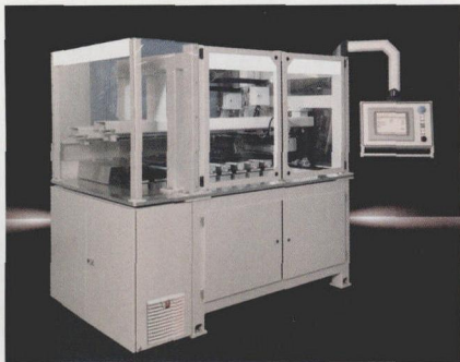
图 3 自动端子机 Athex 可以把大量自动安装在 DIN 导轨上的端子装进开关柜中
