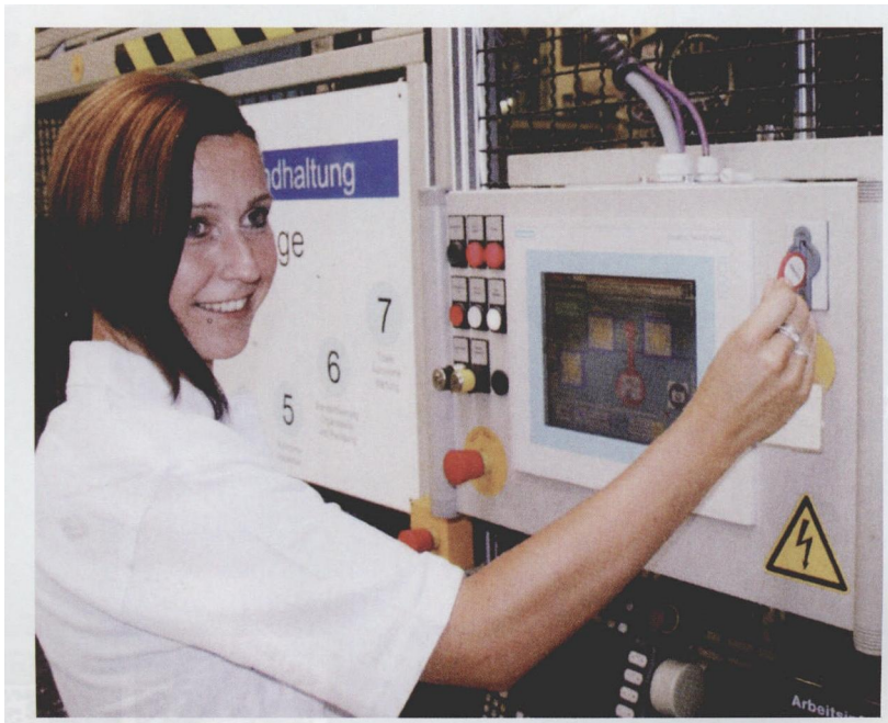
通过使用 Euchner 公司的电子钥匙系统 EKS，博世 - 西门子 Nauen 工厂的职工可轻松接触装配线上的粘接技术设备
