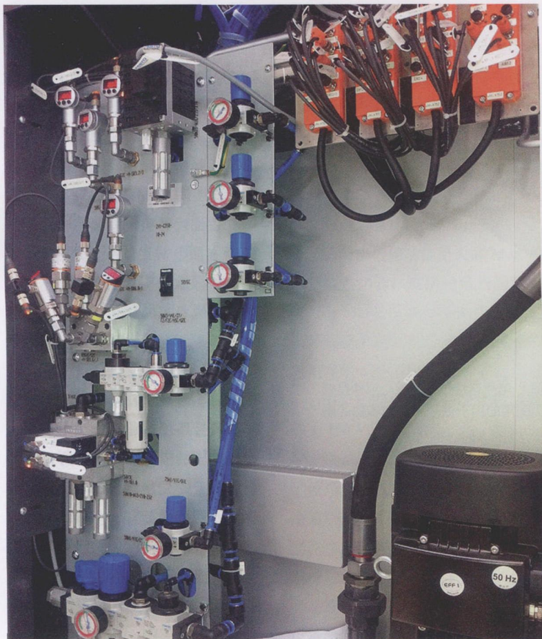
图2 安装在机床冷却站中的同轴阀：易于维护保养的性能使其可以在几分钟内完成阀座的更换
