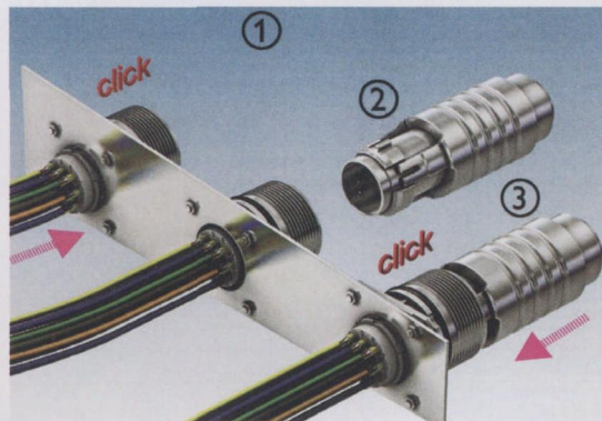
图3 Coninvers 公司研制的圆形连接器具有安装简便且工序安全可靠的特点，绝缘体可从后面啮合（如图中①所示），且可从正面解开（如图中②和③所示）
