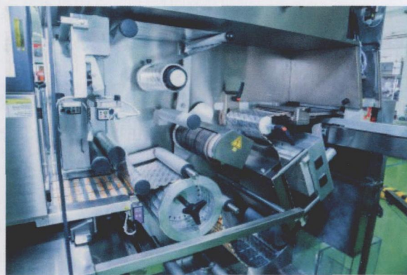
图 2 该机器的主要操作流程包括泡罩成型、装药片、封装泡罩最后是切割泡罩
