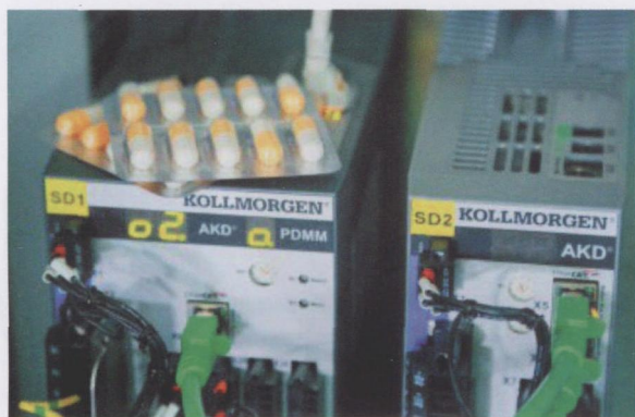
图3 AKD PDMM将高性能PLC和运动控制集成到性能优异的设备中
