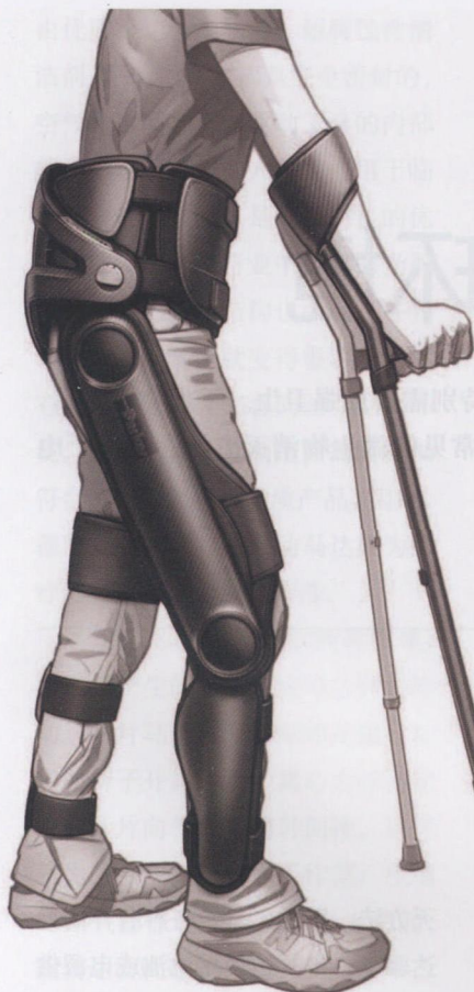
图2 Indego是目前唯一一款结合了功能性电刺激疗法的可穿戴外骨骼产品
