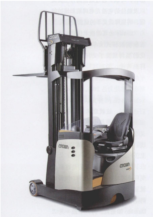
图 3 ESR 5260 型叉车提供 2t 的有效负荷，提升达 13m 高
