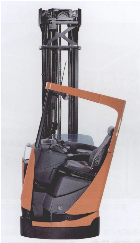
图 5 货叉提升时，BT Reflex 的驾驶室可自动倾斜
