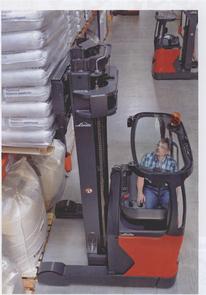
图 1 Linde 公司新一代前移式叉车 R14 ~ R20 的起重能力为 1.4 ~ 2.0t，最大提升高度达 13m
