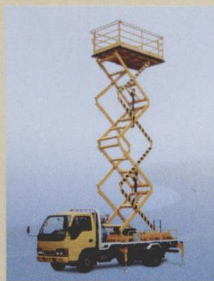
车载式高空作业台
