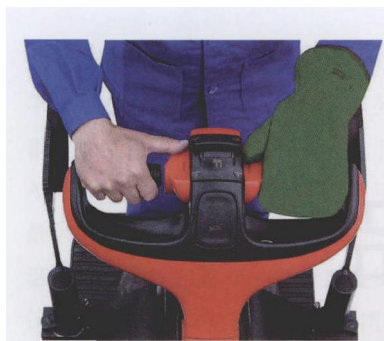
图2 叉车的舵柄空间大，操作者即使戴上手套也能操作自如
