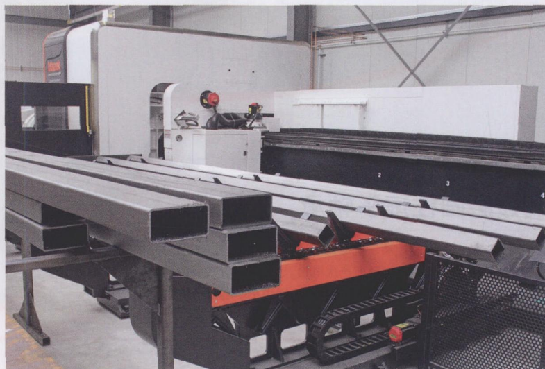
图 2 由于设备采用稳定的浇筑底座，重达 1 t 的部件也可得到很好的加工。此外，管件和型材的可加工长度可以达到 15 m
