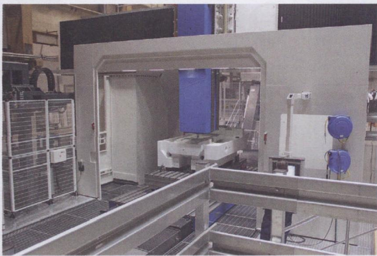
图 1 目前正在 Mikromat 有限公司的车间里进行试运行的是：新型精密门架式铣床，该铣床带有一个新的主轴箱，用于加工最长为 5000 mm、最大重为 38 t 的工件
