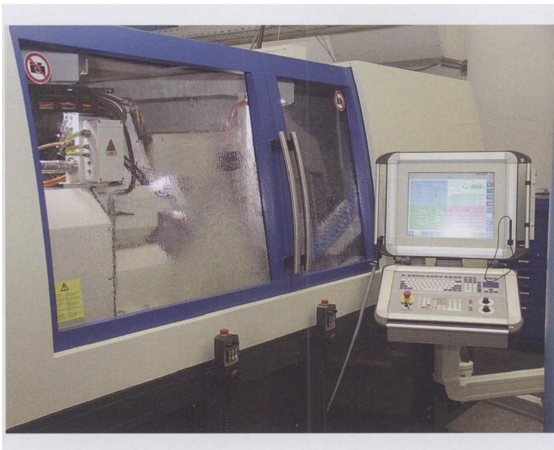
图 2 Mikromat 公司研发的 3G 旋转式螺纹磨床，该磨床的磨加工主轴采用 Torque（外加力矩）传动机构，该磨床不仅可作为外圆磨床进行加工作业，而且可用于铣齿加工作业
