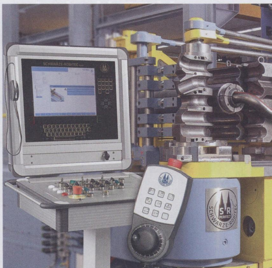
图1 这种易于操作的Schwarze-Robitec机床控制系统能为各个工作步骤同步计数，对成型工艺实施时间优化
